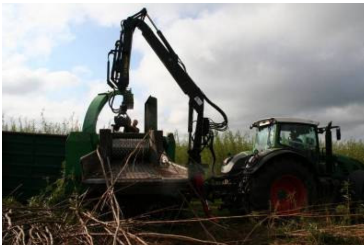
Figur 5 Indføringsbordet på Jenz
